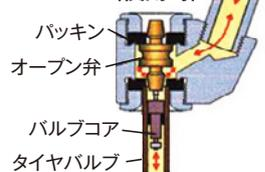
タイヤ内の圧力によって弁とバックシンが密着して内部が密封されます。この状態で、タイヤ内の圧力を充填、測定、調整することができます。
